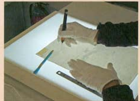
製図ペンは、描く図面の内容によってペン先の太さを使い分けます。
